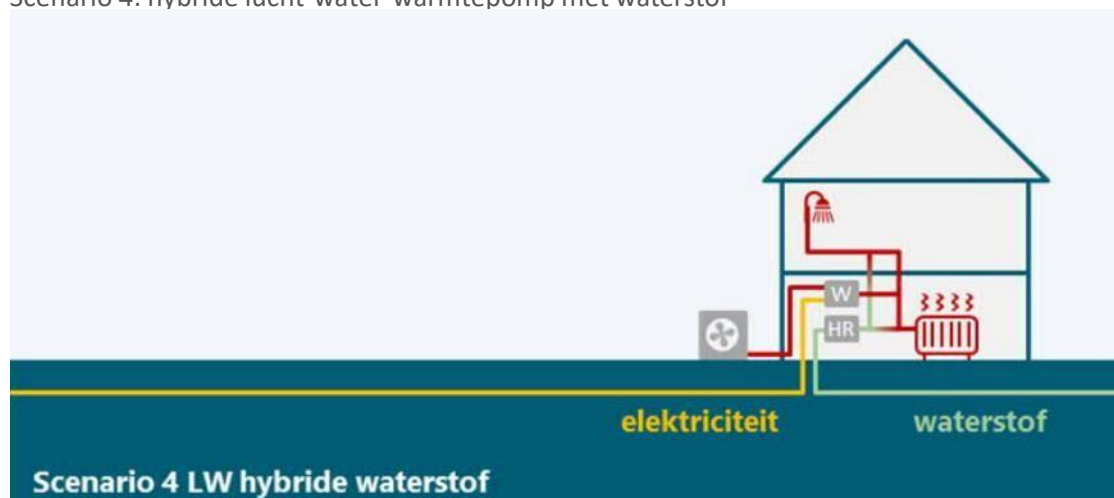
Scenario 4: hybride lucht-water-warmtepomp met waterstof
