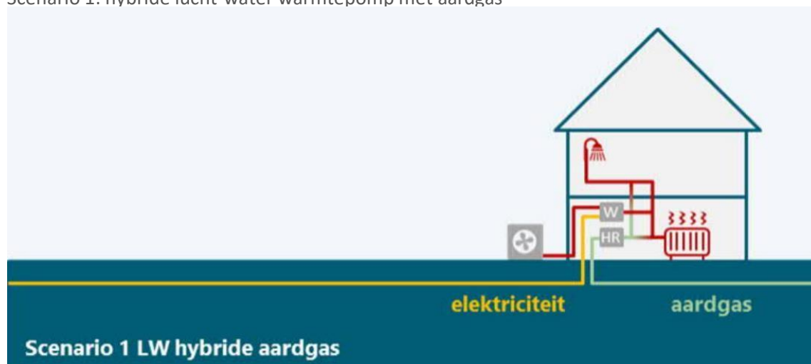
Scenario 1: hybride lucht-water warmtepomp met aardgas
